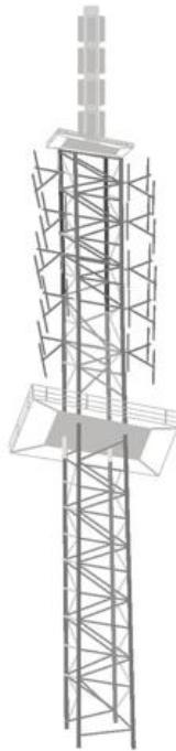
Abb. A4.1 Oberer Teil eines 240 m hohen Antennenträgers mit Rundfunksendeantennen
